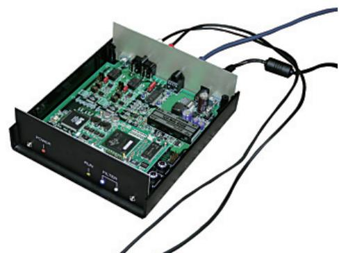
図 2 サンプル値制御理論による最適フィルタを実装した AD 変換器
