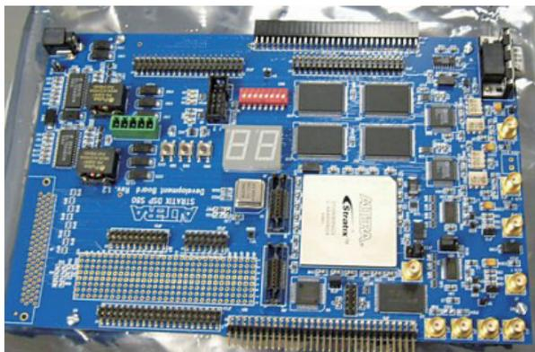
FPGA により試作した 1Gb/s 超高速 MIMO-MLD 回路
